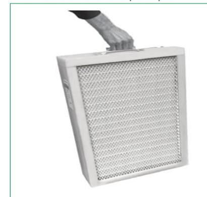
6. Sortir un filtre neuf HEPA de sa boîte. **NB ! Ne pas toucher la surface du filtre pour ne pas l'endommager. Le tenir uniquement par la poignée.** Positionner le filtre, appuyer sur son cadre et plaquer-le contre les perforations. **IMPORTANT :** Le joint noir doit être placé vers les perforations de l'appareil.
